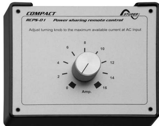
Par exemple si la source est une génératrice de 2000 Watt, le potentiomètre doit être réglé sur 8A max.. Cette valeur est obtenue en divisant 2000 Watt par 230V.
